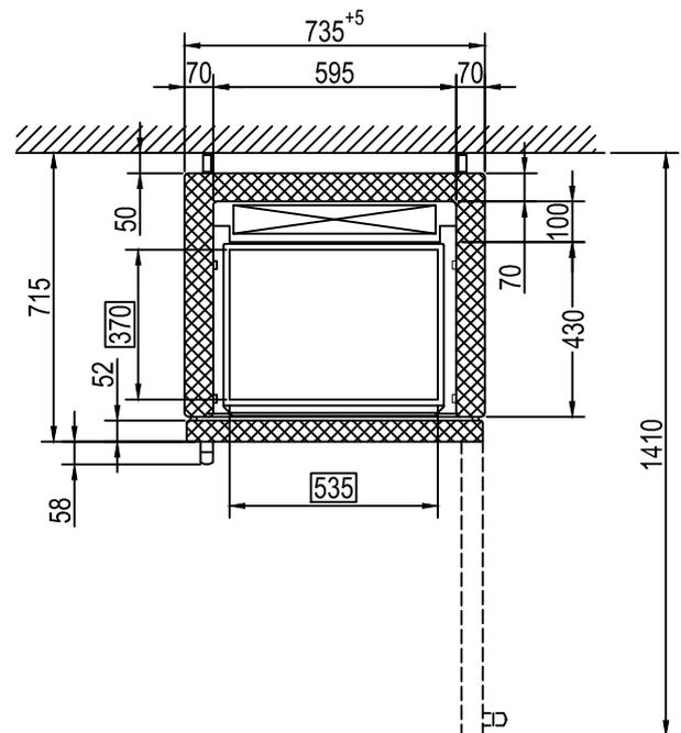
Lüftungsschlitze an der Maschinenraumblende dürfen nicht verdeckt werden.
